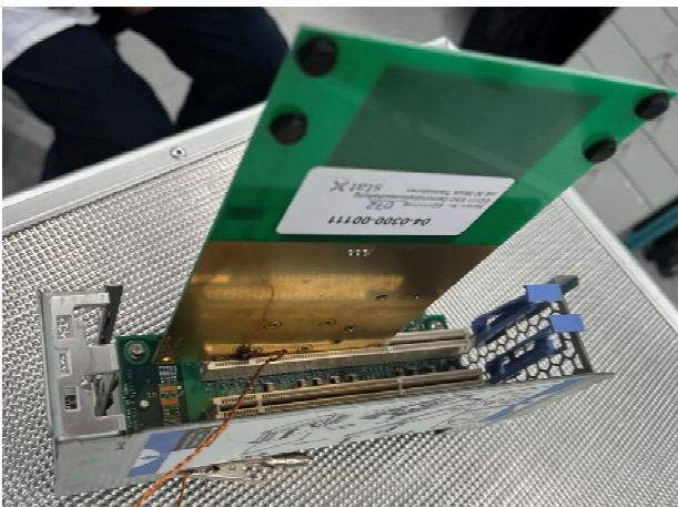
Abbildung 3: Testschaltung ED111 in Zusatzbaugruppe. Diese Stufe wird in dieser Arbeit „Gesamtbaugruppe“ genannt.
