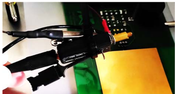
Abbildung 8: Strommesszange CTI mit ED111 auf CPM-Platte als individueller CDM-Testaufbau.
